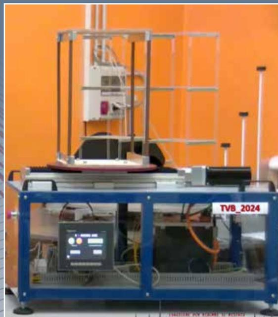
Ed è diventato occasione per momenti di incontro anche con **Associazione Meccanica** che ha fattivamente contribuito per la costruzione del prototipo TVB\_LIN\_2021, la cui parte meccanica (costituita da un motore lineare), per il comando e controllo nell'attuazione di moti oscillatori, è stata posta a confronto con precedenti sperimentazioni realizzate con il prototipo TVB\_2019.
