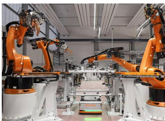
**KUKA** è uno dei leader mondiali nel settore della Robotica Industriale, con 40 sedi nel mondo ed oltre 13.000 dipendenti. Oltre ai robot KUKA produce anche AGV, che utilizza ad esempio negli impianti di produzione delle autovetture, in un concetto di “**matrix manufacturing**” in cui vengono scelte le celle robotizzate in funzione delle lavorazioni di cui il componente ha necessità.
