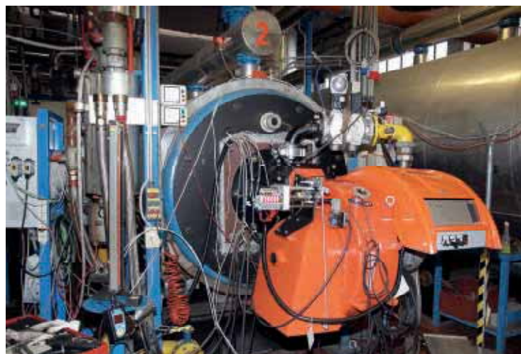
Un bruciatore a gas in fase di collaudo
