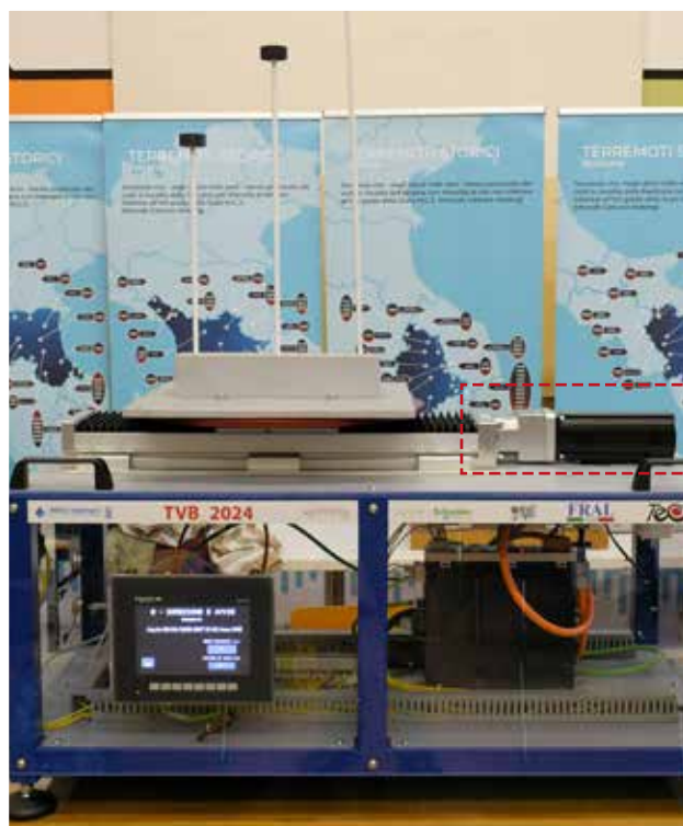
Dettaglio del collegamento tra motore brushless e asse lineare
