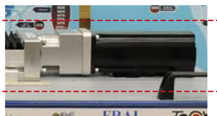
Dettaglio del collegamento tra motore brushless e asse lineare
